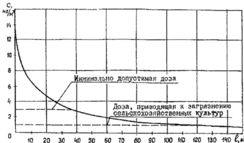
Рис. 1 Загазованность придорожной территории на автомобильной дороге I категории ( N=10000 авт./сут) выбросами автотранспорта (окись углерода)
